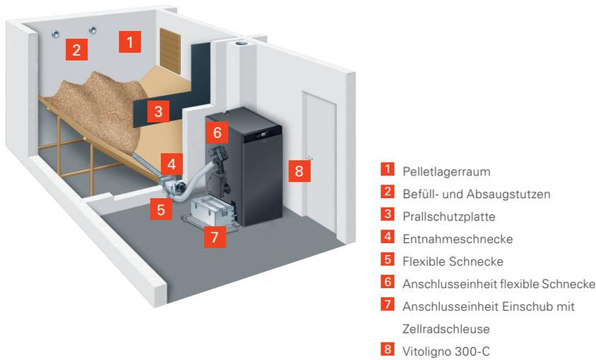
Pelletsilo (Gewebetank) mit Zuführung zum Pelletkessel durch flexible Schnecke
