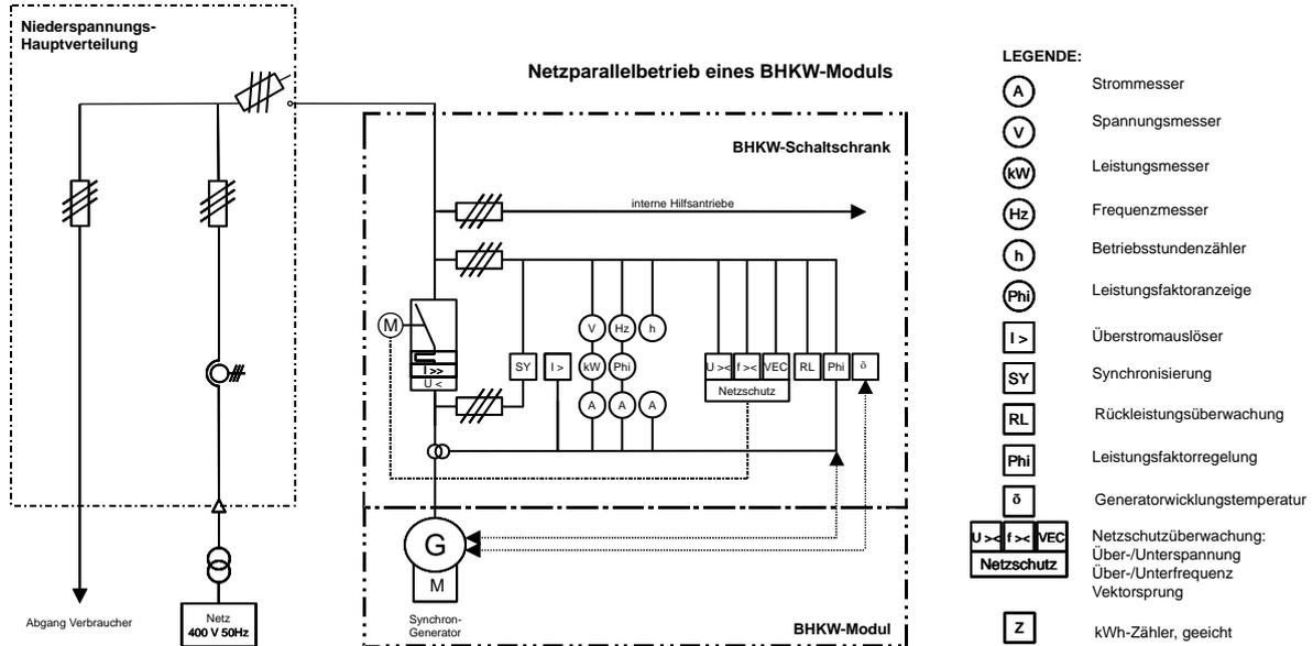
Abb. 3 Prinzipschaltbild der elektrischen Einbindung im Netzparallelbetrieb
