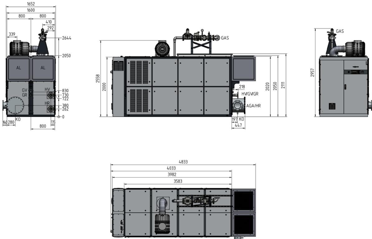
Abb. 5 Abmessungen und Anschlüsse der BHKW Module Vitobloc 200 EM-530/660 mit optionaler Schalldämmhaube (Maße in mm); Die bereits montierte Lüfterbox an der Rückseite kann für das Einbringen des Moduls demontiert werden.
