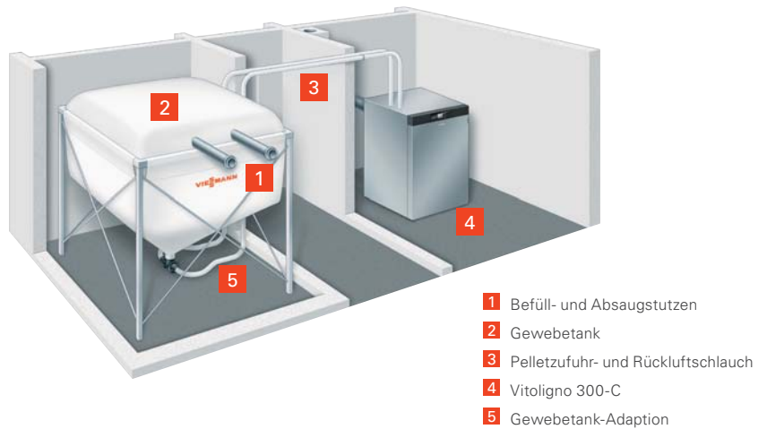
Pelletsilo (Gewebetank) mit Zuführung zum Pelletkessel durch Vakuum-Saugsystem
